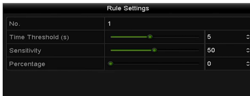
Figure 9.7 Angiv regler for detektering af indtrængning
