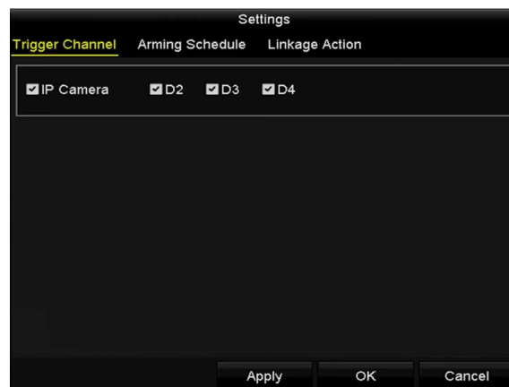
Figure 5. 17 Indstil til udløsning af kamera ved VCA-alarm
