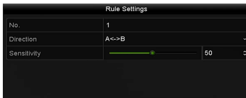
Figure 9.5 Angiv regler for detektering af tværlinje for virtuelt plan
